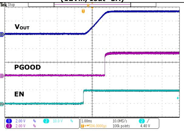
**FIG.21 Turn-on (12Vin, Iout=3A)**
